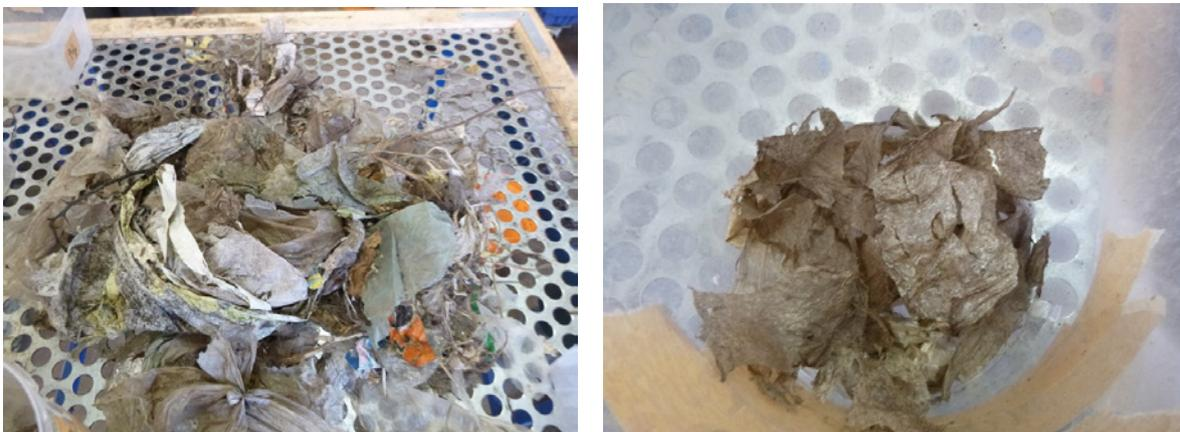
Abb. 97: Material Windsichter-Leichtfraktion auf dem Sortiertisch (links); aus der Windsichter-Leichtfraktion aussortierte, nicht eindeutig bestimmbare Folien (rechts)
