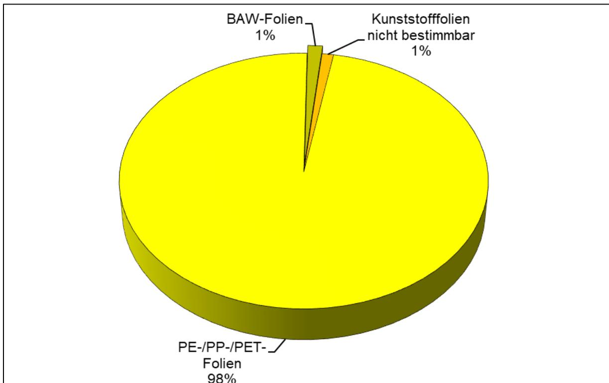
Abb. 96: Zusammensetzung der Folien in der Windsichter-Leichtfraktion (Mittelwert der drei Untersuchungen)
