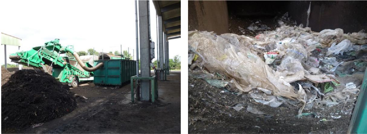
Abb. 93: Aufbereitung des Fertigkomposts in Aiterhofen (links); Windsichter-Leichtfraktion im Container (rechts)
